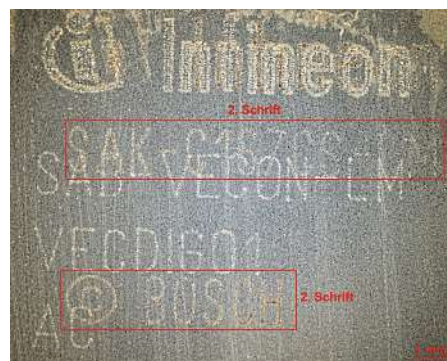
Umbeschriftetes Bauteil: Nach dem Wischtest erscheint die ursprüngliche Beschriftung.
