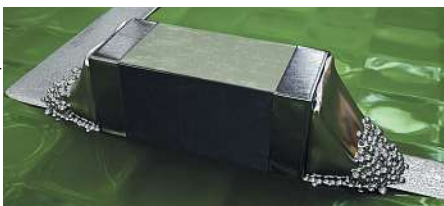
Bild 11: Darstellung von typischem Graping (Traubenbildung)
