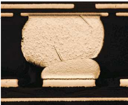
Bild 10: Typisches HIP-Problem bei zu langer und zu hoher Soak-Temperatur. Dieser Fehler könnte im Funktionstest unerkannt durchgehen und wird später einen Ausfall im Feld verursachen.
